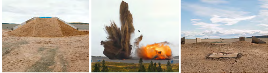
Utkast av fragmenter ved eksplosjon i et eksplosivlager, fra jordoverdekkede forsøk utført på Rena. FOTO Hans Fredrik Asbjørnsen
