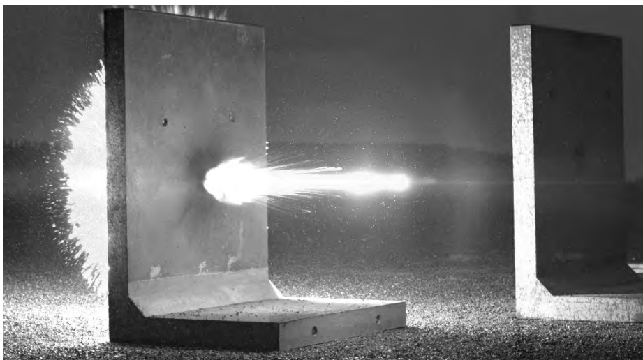
Effekten av RPG-7 avfyrt mot et betongelement.
