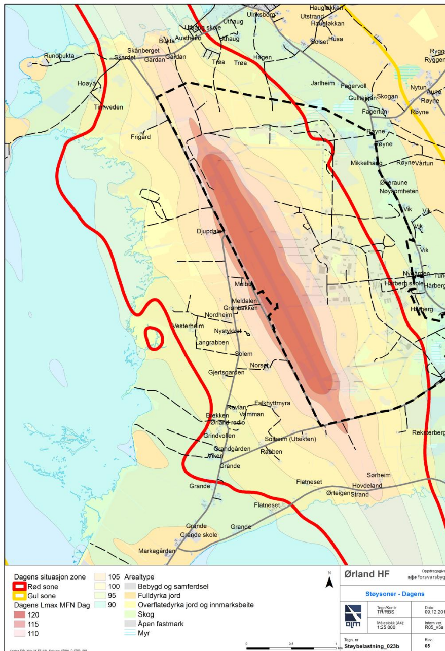
Figur 40. Dagens støybilde. Utbredelse av koter for MFN_{day} for 120 dBA, 115 dBA og 110 dBA, for dagens situasjon.
