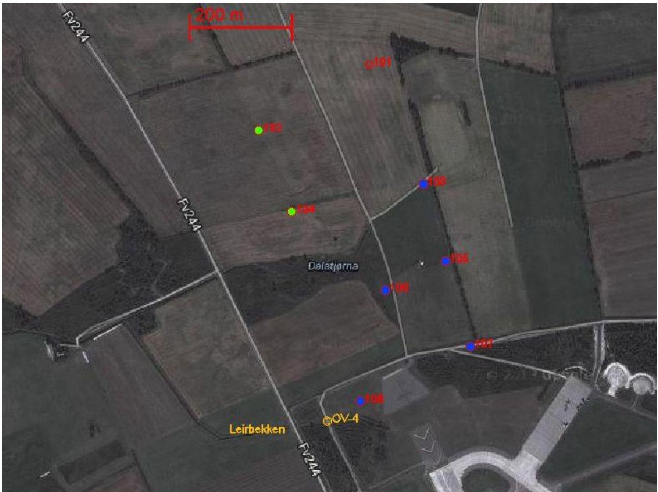
Figur 4-2 Prøvepunkter i område for rullebaneforlengelse (nord for eksisterende rullebane). Utsnittet viser 8 borpunkter, samt vannprøvetakingspunktet i Leirbekken (OV-4). Prøvepunktene er fargelagt iht. analyseresultat sammenholdt med "Helsebaserte tilstandsklasser for forurenset grunn". Kartunderlag: maps.google.no
