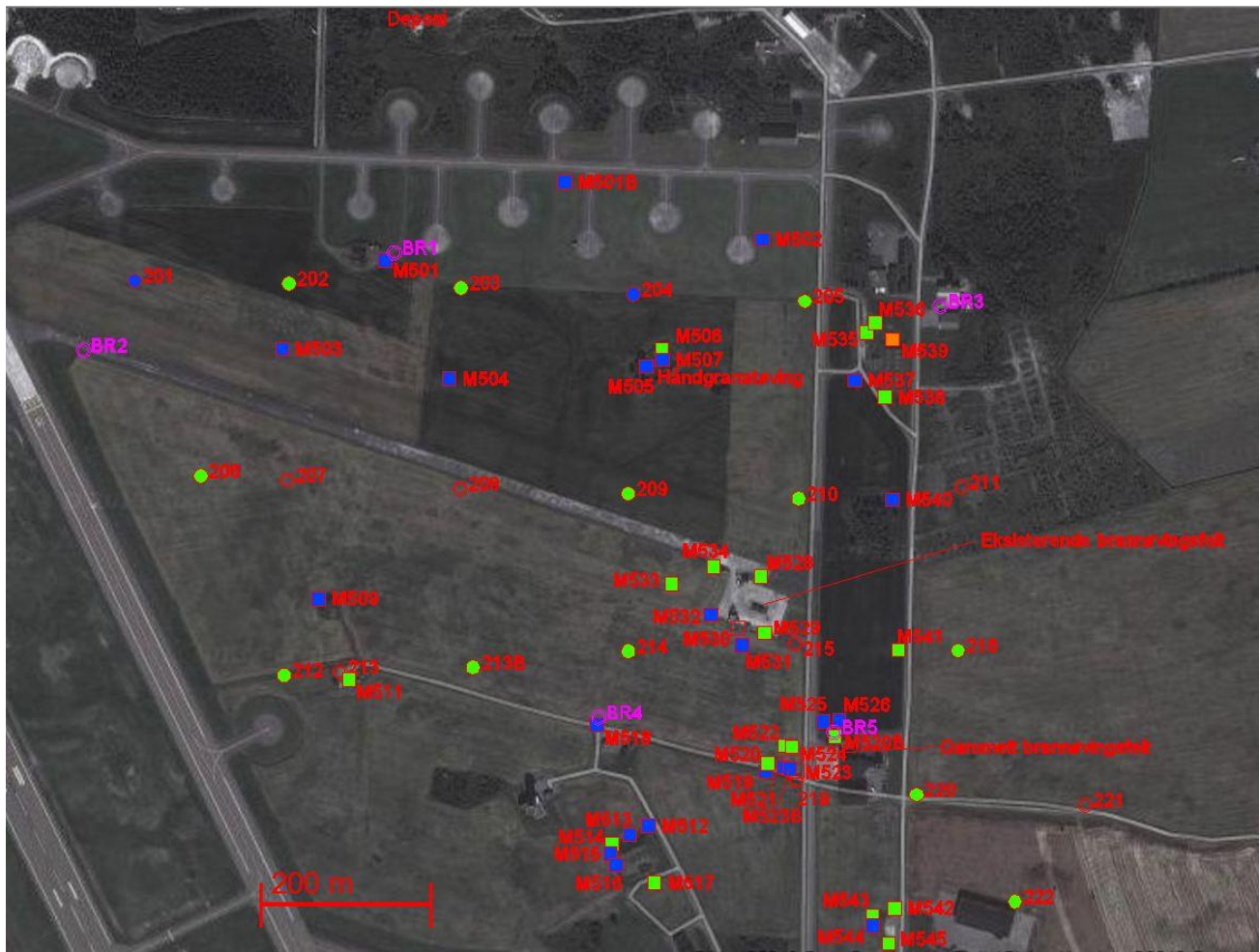
Figur 4-3 Prøvepunkter i F35-området, dvs. område med mest omfattende planlagte terrenginngrep. Kvadrater markerer gravemaskinsjakter, sirkler med rød tekst markerer borpunkter. Overvåkningsbrønner er vist med rosa sirkler (BR1-BR5), jfr. også Figur 4-5. Prøvepunktene er fargelagt iht. analyseresultat sammenholdt med "Helsebaserte tilstandsklasser for forurenset grunn". Kartunderlag: maps.google.no
