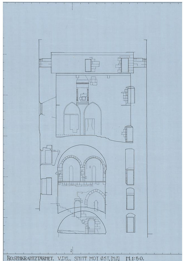
Hvelvet fra 1748 over kongens sal i 2. etasje var 1,5 m tykt. Det ble tatt ned i 1955 ved tilbakeføring av middelaldertårnets etasjehøyder.
