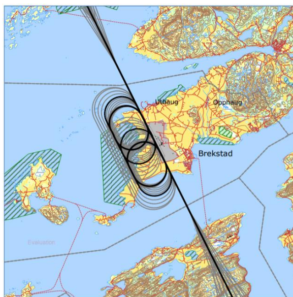
Figur 2 Landingstraséer for jagerfly med statistisk sideveis spredning med landingsrunder
