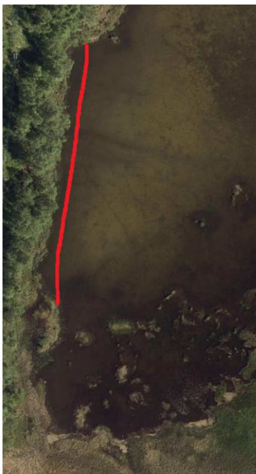
Figur 10 Foreløpig forslag til plassering av siltgardin i sørvestre hjørne av Svanevatn. Nødvendig lengde anslås til mellom 75 og 100 meter.
