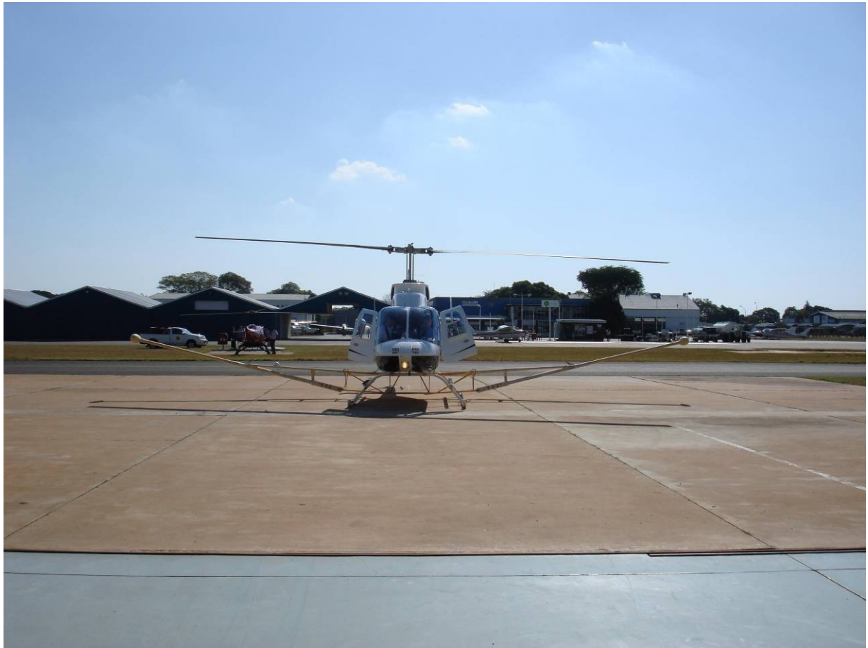
Figur 1. Horizontal magnetisk gradient system (Foto: George Lev).
