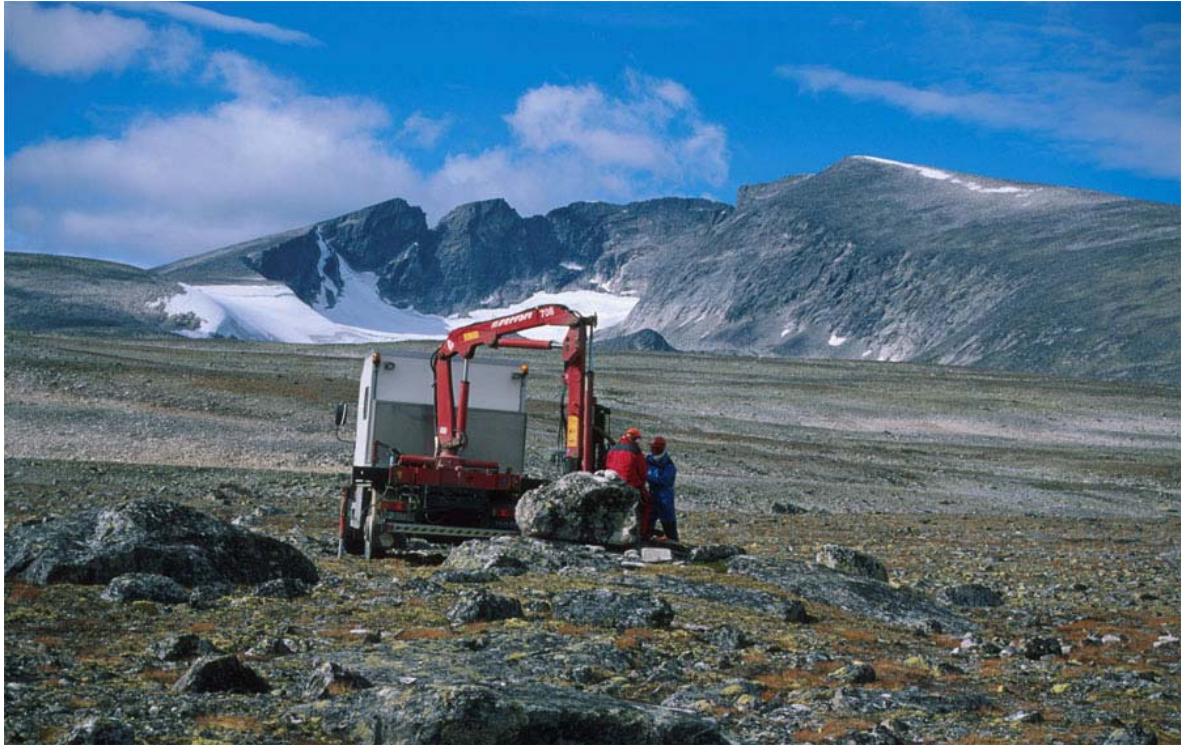
Figur 3.2. Boring av et 10 m dypt hull (DB1) ved Snøheim, september 2001. Borehullet er lokalisert 1505 m o.h. Foto: Ketil Isaksen
