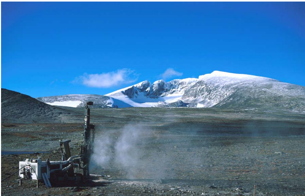
Figur 3.3. Boring av et 9 m dypt borehull (DB2) ved Snøheim, oktober 2001. Borehullet er lokalisert 1481 m o.h. Foto: Ketil Isaksen
