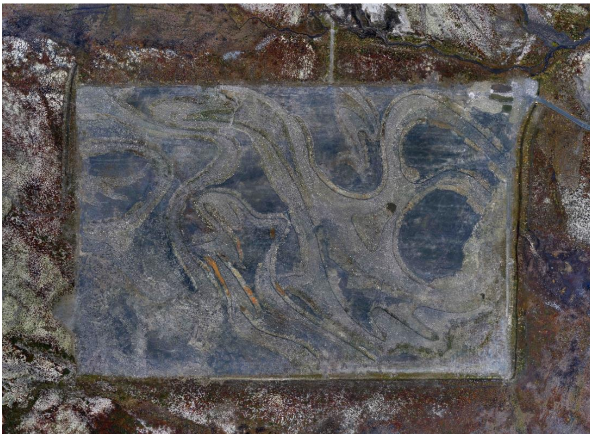
Figur 6 HFK-sletta høsten 2015, fotografert fra drone 100 m over bakken. Bildet viser strukturene av terrengforming og omrøring i toppmassene. Grøfta under og til høyre på bildet vil bli fjerna i 2016 og bidra til utvisking av grensa på opprinnelig vegetasjon utover Stormyra.
