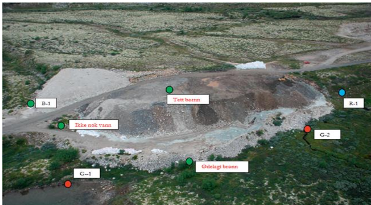
Figur 9 Figuren viser alle prøvetakingspunktene ved deponiet på Storranden. Fire av punktene (grønne) er miljøbrønner satt ned i grunnvannet, to (røde) er grunnvannsutslag og (blå R-1) er brønn for måling av bakgrunns verdier. En ny referansestasjon (R-2) er ikke med på bildet og befinner seg i utslag ca. 100 m til høyre for R-1.
