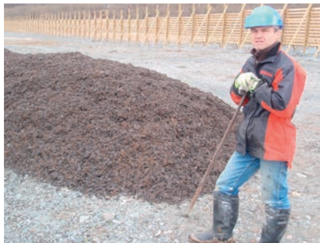
Fig. 33. Dekk-klippet som ble benyttet i rislefilteret var multiklipp med midlere flakstørrelse på ca. 20 mm. Det ble benyttet i alt 30 tonn i filteret
