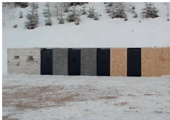
Fig. 3. Fra forsøkene med energidempende fangmaterialer på bane 2 i Rena leir. I dette oppsettet ble forskjellig materiale fra lettbetong til endetre og plastgranulat testet. Konklusjonene fra dette og andre forsøk var at dekk-klipp er det beste fangmaterialet når alle forhold tas i betraktning.
