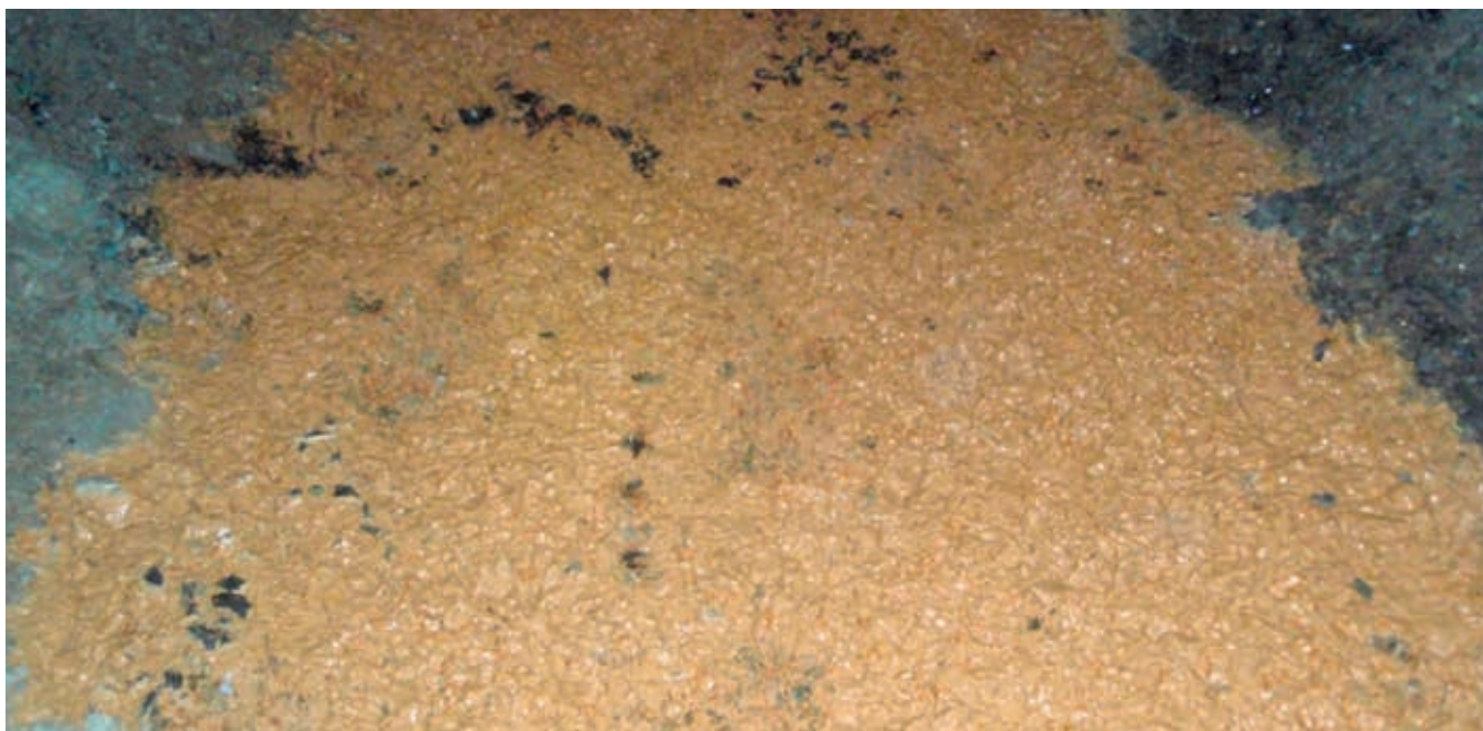
Fig. 35. Overflaten av riskefilteret etter to måneders drift. Dekk-klippet er fullstendig dekket av et gulbrunt jernslam.
