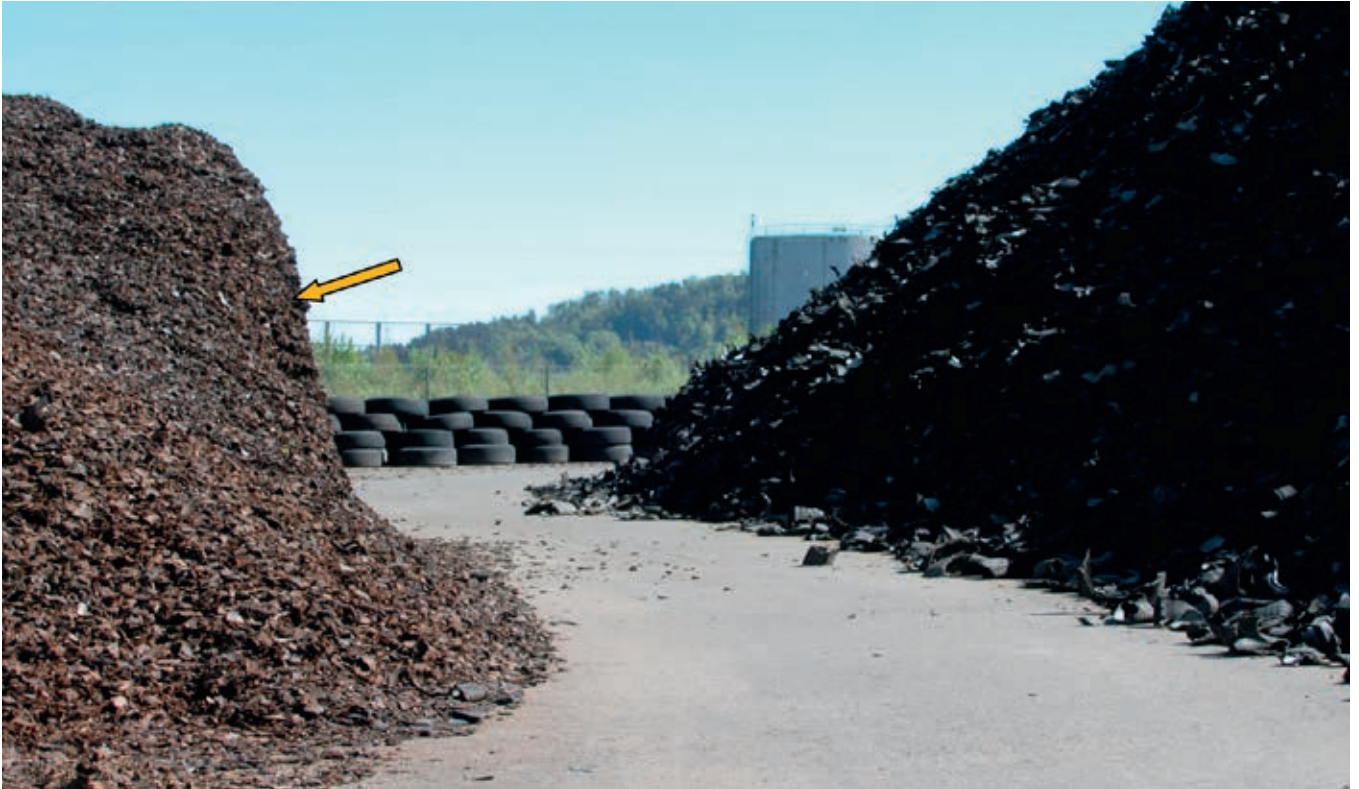
Fig. 19. Fra Ragn-Sells lager for dekkklipp på Skjerkøya ved Langesundsfjorden. I haugen til venstre ligger dekk som er klippet 2 ganger (multi-klipp), mens haugen til høyre inneholder enkeltklipp. Legg merke til multiklippets rasvinkel som er tilnærmet 90^\circ .
