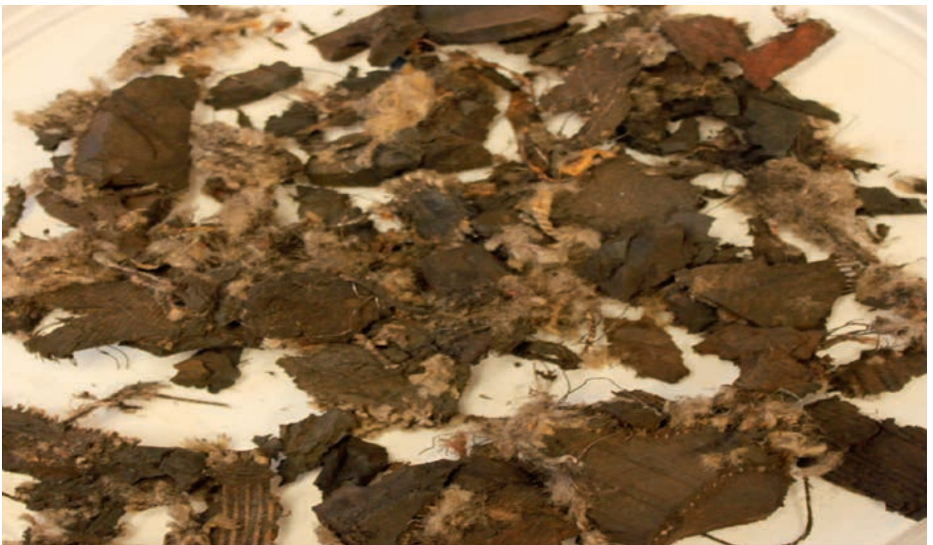
Fig.67. Dekk-klipp fragmentert av prosjektiler. Bitene er mindre og har en utflytende form. Tekstilene er revet opp og danner dotter som har en positiv effekt på spredningen av gummistøv, men øker faren for brann.
