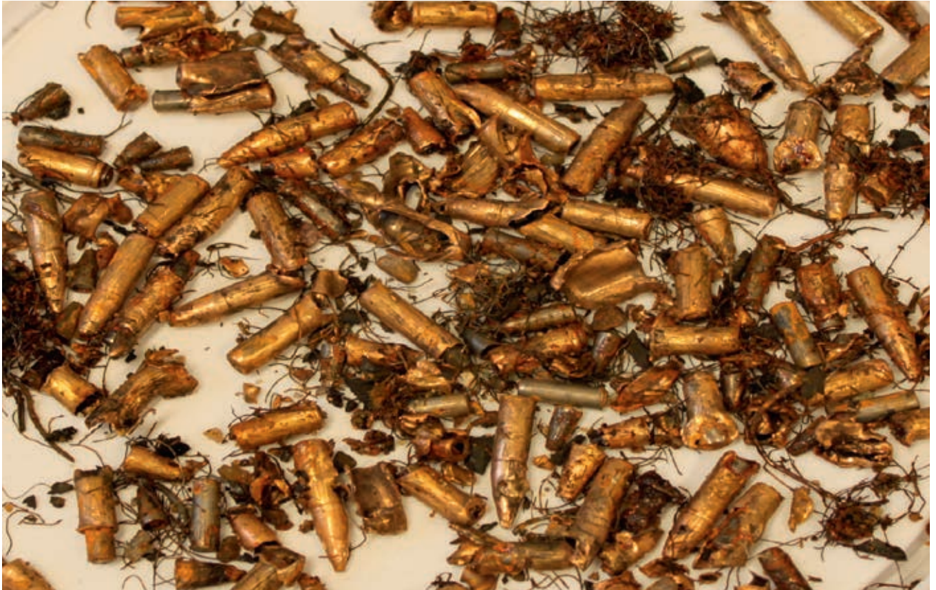
Fig. 68. Prosjektiler og prosjektilrester skilt ut fra mettet dekk-klipp ved flotasjon. Over 90 % av prosjektilene ble skilt ut fra gummien i prosessen. De mørke dottene som ligger spredt i bildet er sammenfiltret cord.
