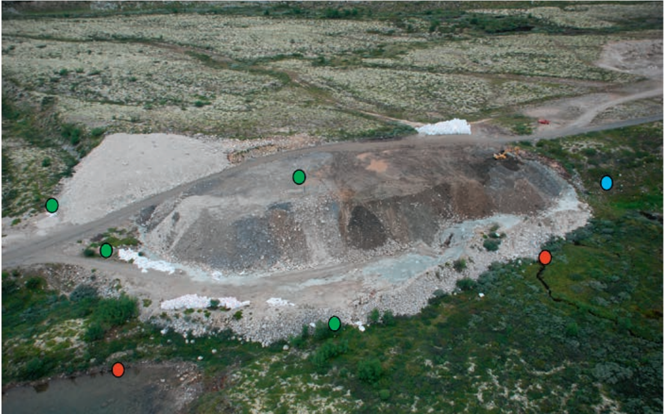
Fig. 51. De 7 prøvetakingspunktene ved deponiet for sterkt forurensede masser. Fire av punktene (grønne) er miljøbrønner satt ned i grunnvannet, to (røde) er grunnvannsutslag og én (blå) er brønn for måling av bakgrunnsverdier.
