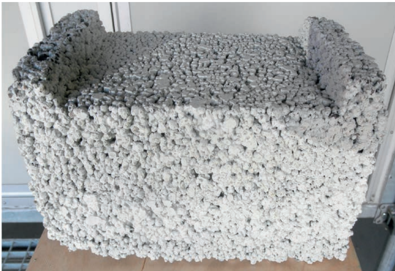
Fig. 17. Renseblokk med olivingranulat som reaktivt medium. Blokkene er erosjonsbestandige og har høy permeabilitet. Produktet vurderes som spesielt godt egnet i kontaktfiltere.
