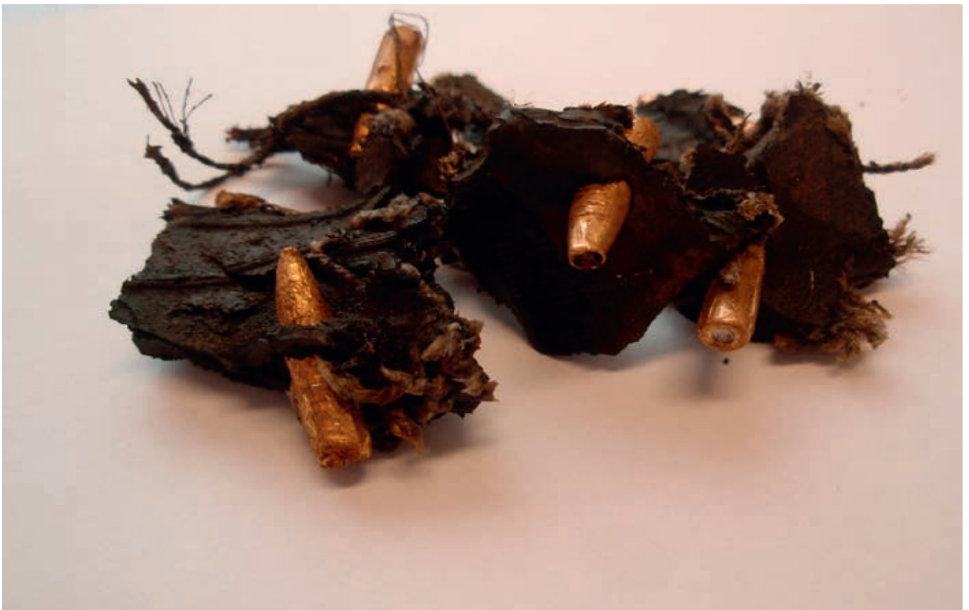
Fig. 69. Dekk-klippbit tatt fra kortholdsbanen på Rødsetra i Regionfelt Østlandet. Bildet viser hvordan prosjektilene kiles fast i gummien med minimal fragmentering. Gummibiter med fastkilte prosjektiler bunnfelles sammen med rene prosjektiler i flotasjonen.
