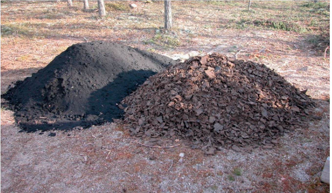
Fig. 18. Dekk-klipp kan ha svært forskjellig kornstørrelse eller flakstørrelse. Den mørke massen til venstre i bildet er finmalt gummi hvor corden er fjernet. Haugen til høyre er et dobbeltklipp, dvs. at dekkene er klippet 2 ganger.
