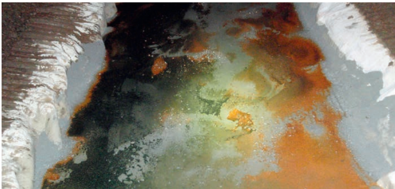
Fig.32. Utsnitt av den reaktive kanalen i Jernbanestollen i Tverrfjellet gruve. Kanalen, som var 1,2 m bred og 10 m lang, ble belastet med 3 l gruvevann pr. sekund. Fargespillet i vannet skyldes først og fremst forskjellige oksidasjonsstadier for jern og kobber.
