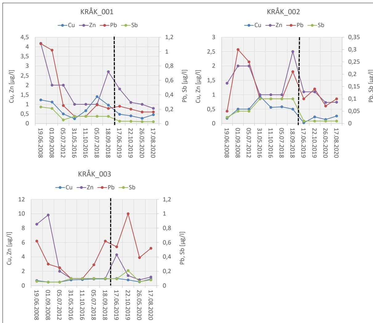
**Figur v1.** Årlig variasjon i konsentrasjoner av bly (Pb), kobber (Cu), sink (Zn) og antimон (Sb) på Kråkenesmarka SØF i perioden 2008-2020. Punkt 1 er et internpunkt, punkt 2 er et referansepunkt og punkt 3 er et kontrollpunkt. Fra og med 2019 ble det analysert på filtrerte prøver, og overgangen fra ufiltrerte til filtrerte prøver er angitt med sort, stiplet vertikal linje.
