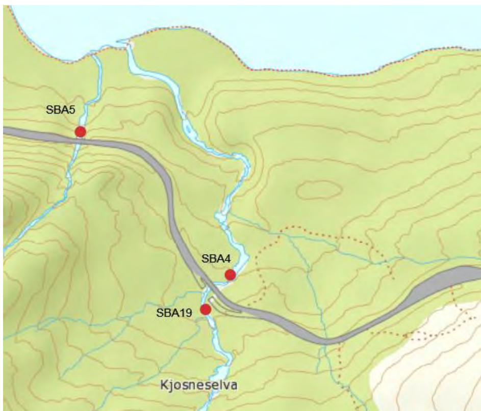
Figur 8. Plassering av prøvepunkt oppstrøms og nedstrøms vegtraséen. Ved prøvepunkt SBA5 stuper bekken bratt forbi vegen uten av tilsig fra vegen ble vurdert som aktuelt.
