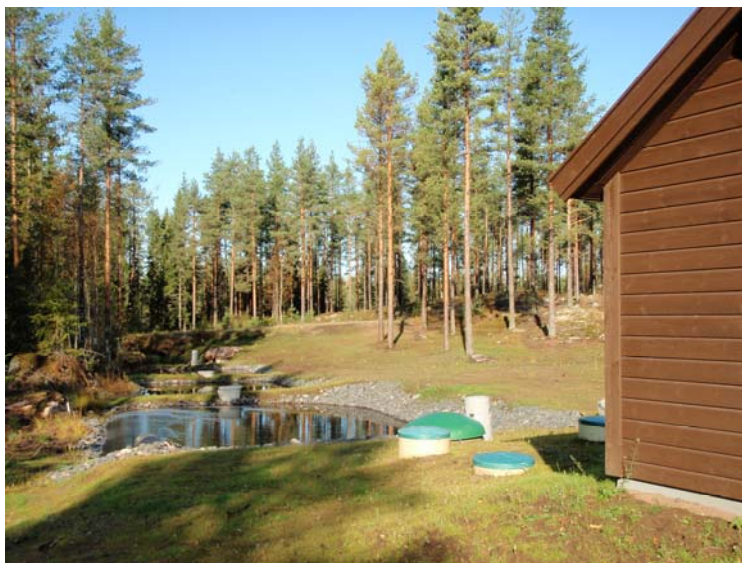
Forsvarsbygg prøver å finne gode metoder for å redusere avrenning av metaller. Her testes sedimentasjonsdammer og kjemikalietilsetning i Miljølab i Terningmoen skyte- og øvingsfelt. Foto: Grete Rasmussen, Forsvarsbygg.
