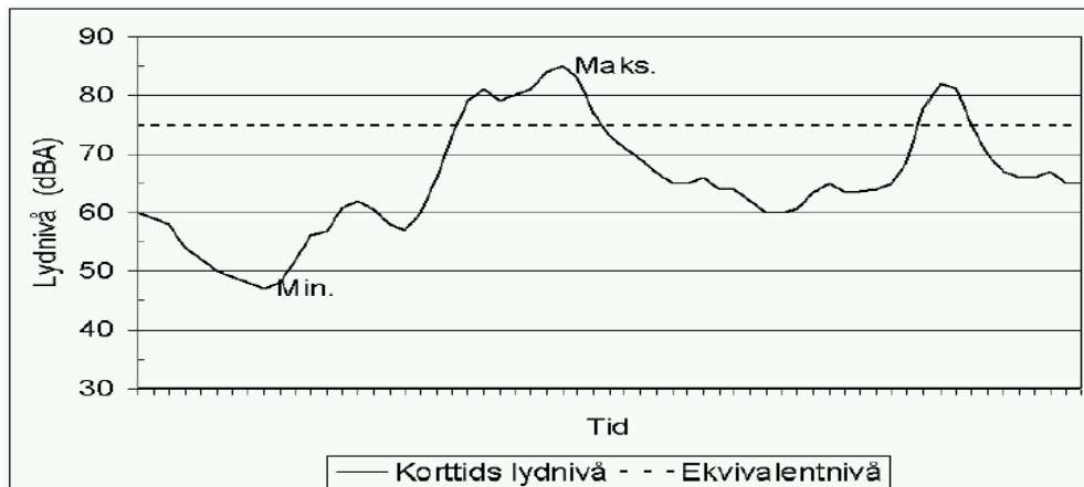
Figur 5: Figuren viser forskjellen mellom maksimalt- og ekvivalent lydnivå
