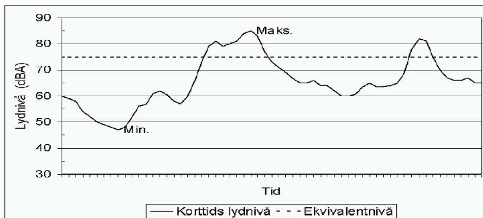
Figur 4: Figuren viser forskjellen mellom maksimalt- og ekvivalent lydnivå
