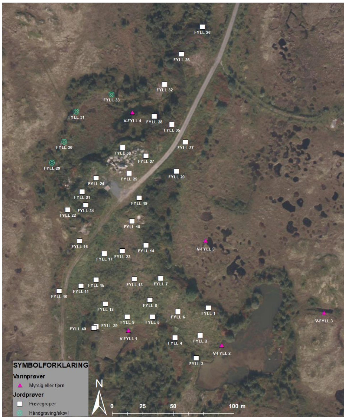
Figur 3.1: Kart over undersøkt området i og rundt avfallsfyllingen, samt plassering av prøvepunkter for løsmasser og overflatevann.
